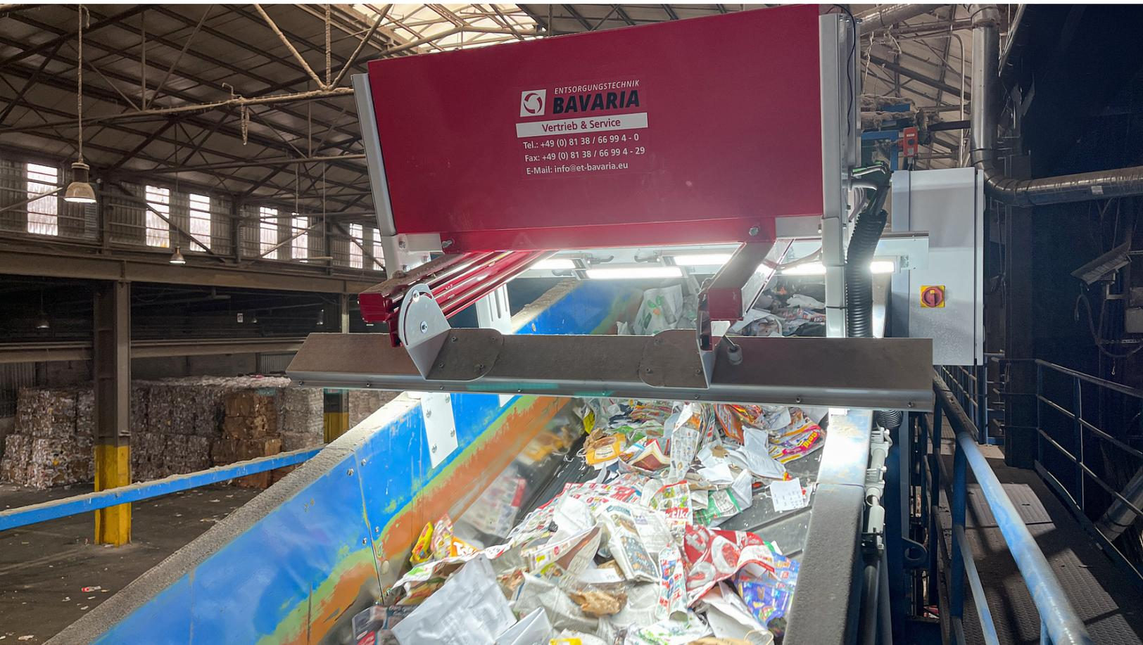
Die MaxPosCam des Herstellers Entsorgungstechnik Bavaria GmbH ermöglicht eine präzise und kontinuierliche Überwachung des Sortierprozesses für Deinking-Altpapier in Echtzeit.
